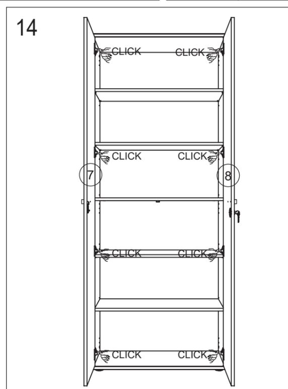
Voor de juiste regeling van de deuren moet U ervoor zorgen dat de kast goed waterpas staat, U kunt met de schroeven van de scharnieren 204 de deuren bijregelen. U kan ook de deuren vertikaal bijregelen. Ontspan vijzen A en schuif de scharnierblok nr. 203 naar onder of naar boven en schroef terug vast.
