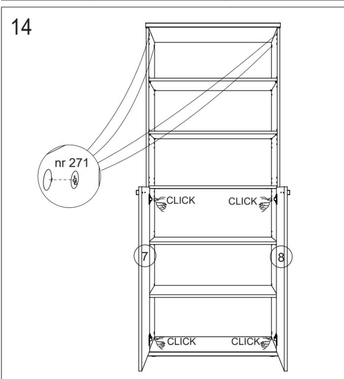
Voor de juiste regeling van de deuren moet U ervoor zorgen dat de kast goed waterpas staat, U kunt met de schroeven van de scharnieren 204 de deuren bijregelen. U kan ook de deuren vertikaal bijregelen. Ontspan vijzen A en schuif de scharnierblok nr. 203 naar onder of naar boven en schroef terug vast.
