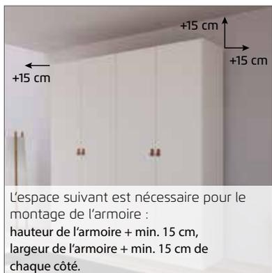
L'espace suivant est nécessaire pour le montage de l'armoire :
